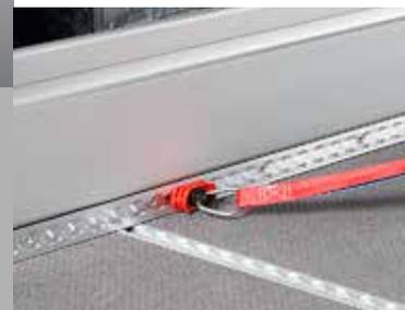
Ancoraggio sicuro - vasta gamma di accessori fermacarico
